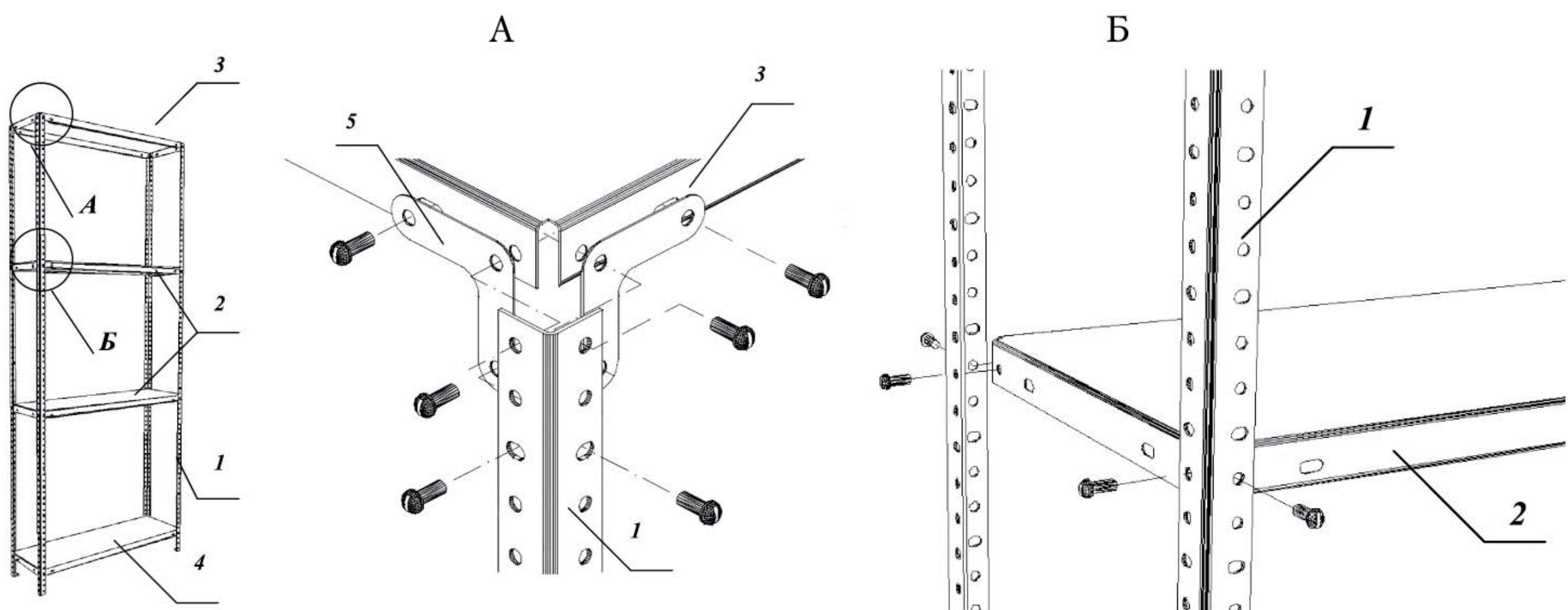
РИС. 2. Сборка одной секции стеллажа ТС
