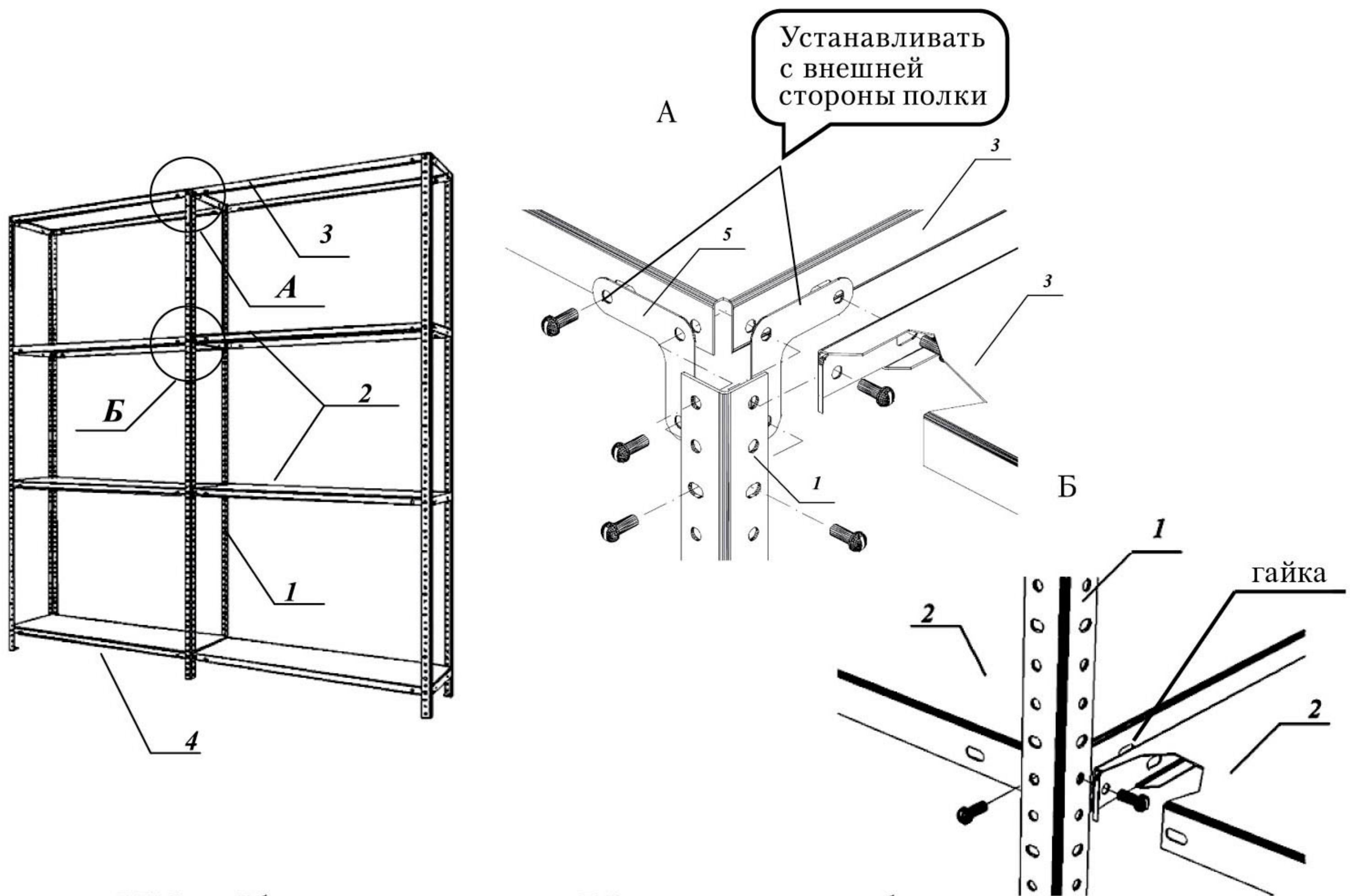
РИС. 3. Сборка стеллажа серии ТС ленточным способом
